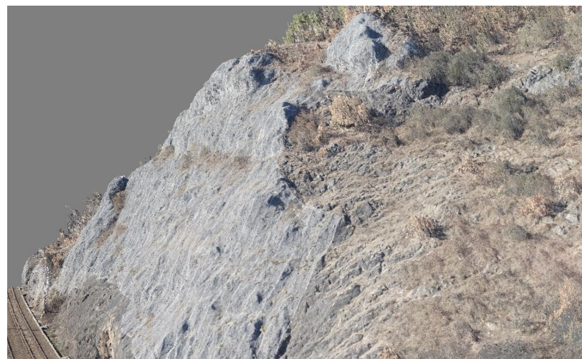
mračno bodů – digitální fotogrammetrie, dron
